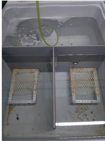
Figure 22 : Vue du dessus du dispositif expérimental à homard. Le tube vert approvisionne le bassin en oxygène. Il a toujours été placé sur le grand compartiment depuis lequel le homard a débuté sa période d'acclimatation au début de chaque essai.
