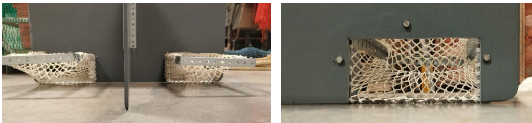
Figure 23 : À gauche : Vue des petits compartiments de contrôle et de test du dispositif expérimental à homard. À droite : Vue de l'entrée depuis le grand compartiment où le homard débute l'expérience.
