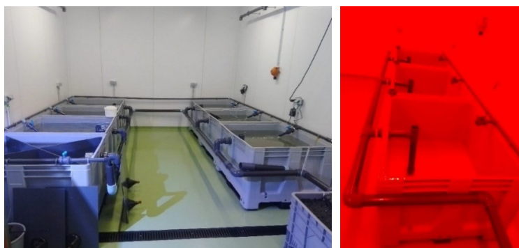
Figure 14 : Aperçu des bassins à bouquet. À gauche : Aperçu de la pièce avec 7 bassins de 450 litres de 110 x 90 x 50 cm. À droite : La pièce en lumière rouge, invisible pour la plupart des animaux marins. Ce type de lumière est utilisé pendant la phase "nuit" de l'expérience pour travailler avec le moins de perturbations.
